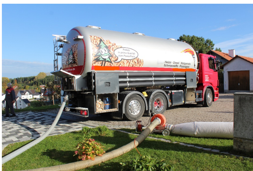
Kamion za dostavu peleta do skladišta
