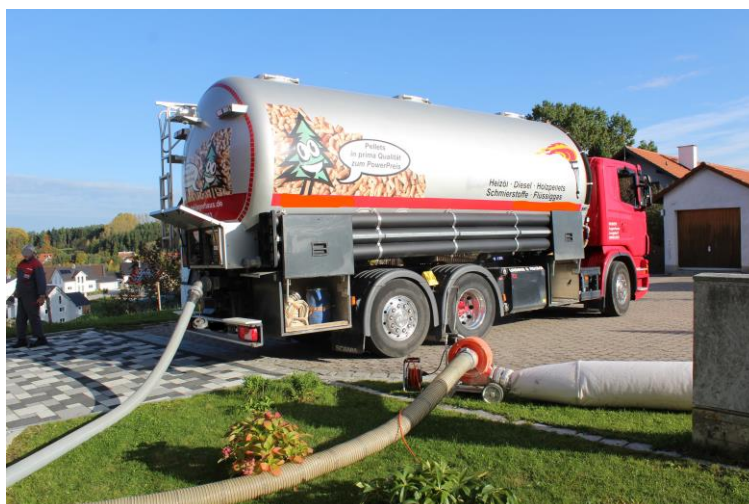
Camión de reparto suministrando pellets de madera a una vivienda
