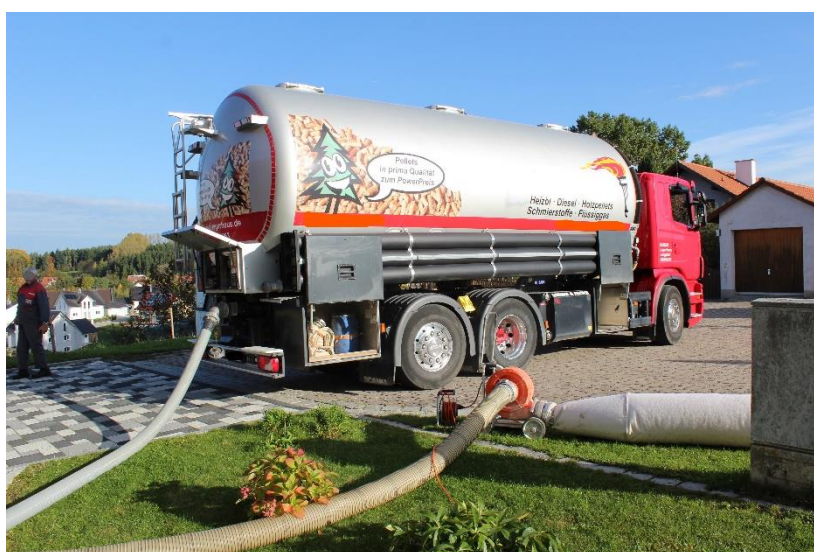
Kamion za dostavu peleta do skladišta
