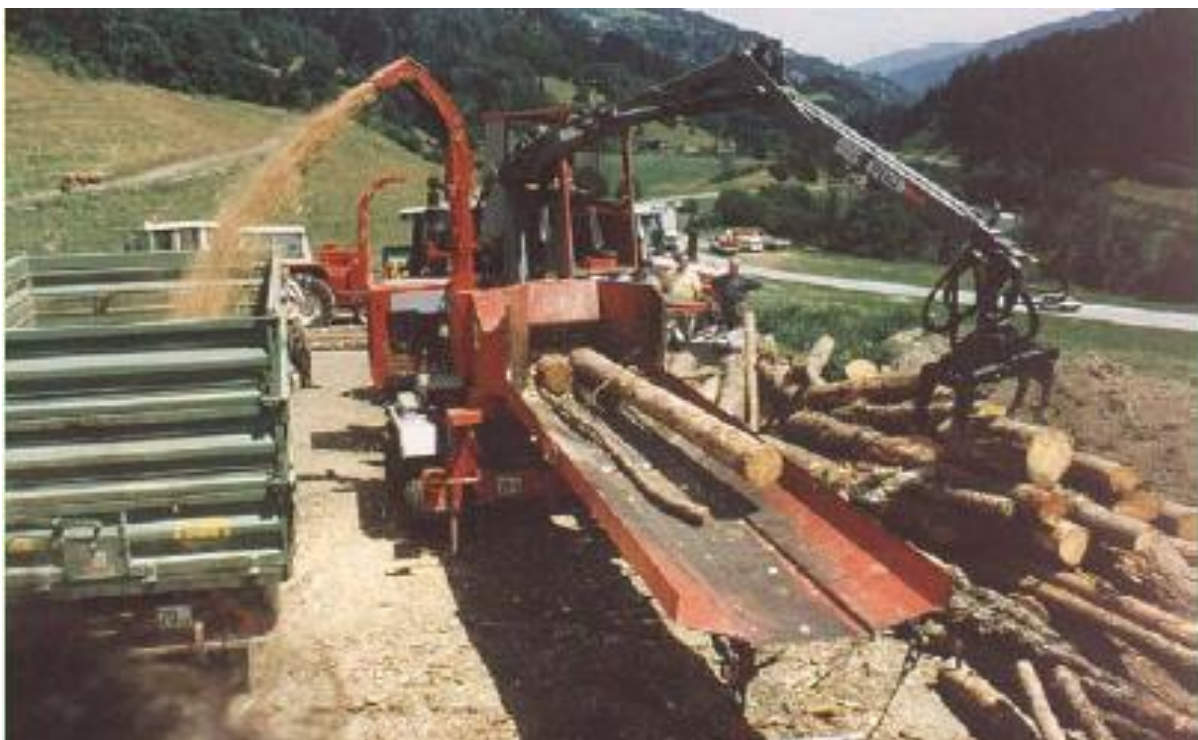
Abbildung 16 Holzhacker mit mechanisierter Zuführung
