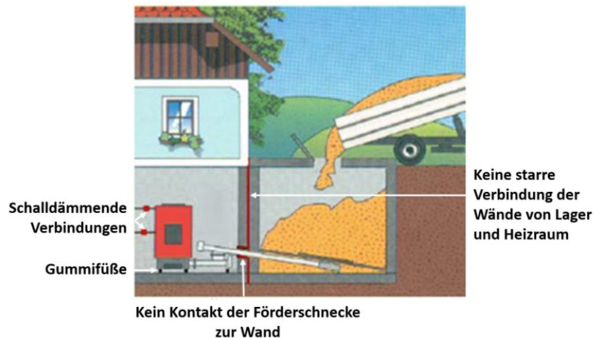
Abbildung 15 Elemente für den Lärmschutz
