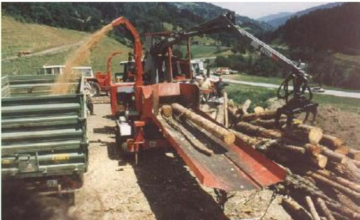
**Figura 18** Astilladora de madera con alimentación mecanizada
