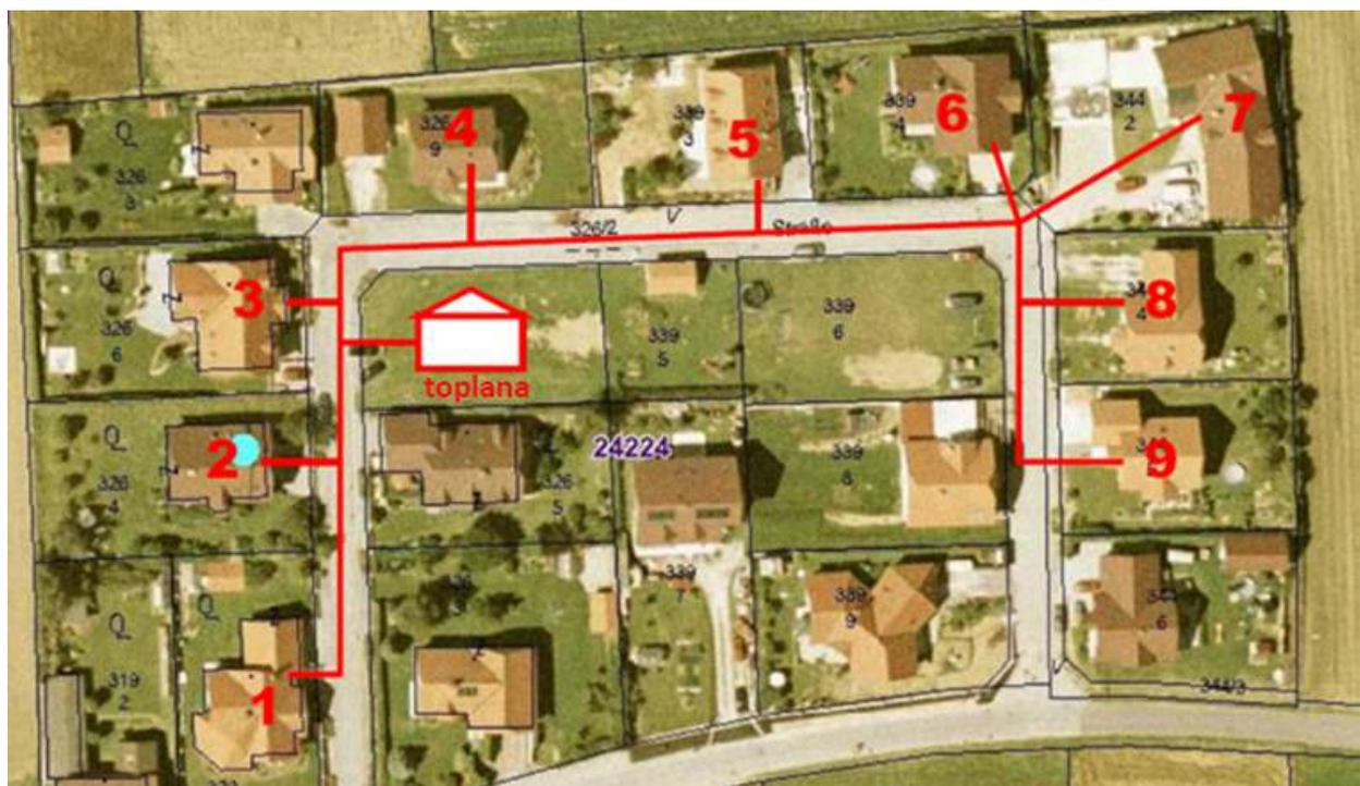
**Slika 9** Korištenje kotla na drvnu sječku u stambenom sektoru za grijanje grupe domova
